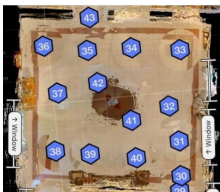
Εικόνα 29: Σημεία τοποθέτησης κάμερας – Οριοθέτηση παραθύρων & καθρεφτών
