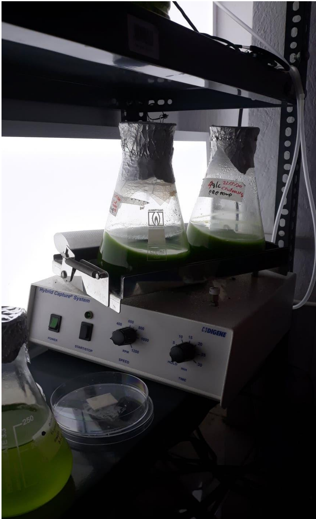
Εικόνα 1.3 Ανάπτυξη καλλιεργειών μικροφυκών με φωτισμό 16/8 ώρες φως/σκοτάδι
