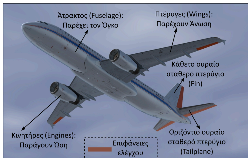
Σχήμα 11. Σχέδιο που απεικονίζει τα σημαντικότερα κομμάτια του αεροσκάφους.
