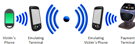
Σχήμα 23: Relay Channel (Gurulian.I et al, 2017)
