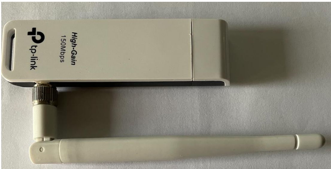
Εικόνα Β. 17 Wifi USB αντάπτορας για ενίσχυση του σήματος
