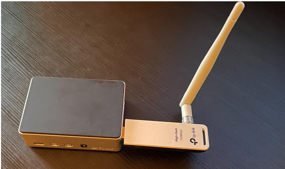
Εικόνα Β. 18 Wifi USB αντάπτορας στο raspberry pi 4 Model B
