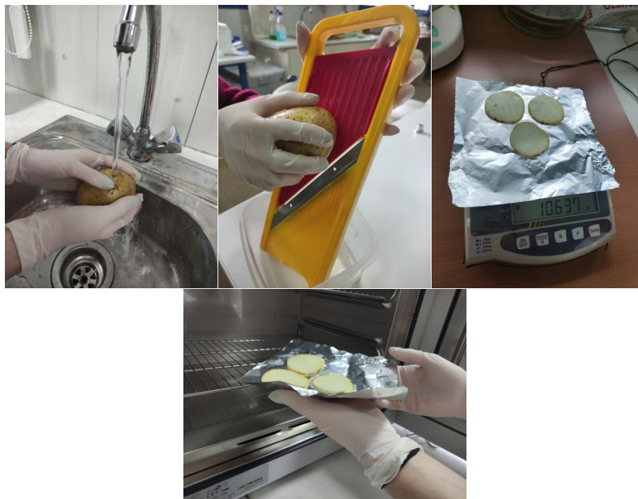
Εικόνες 50-53. Πλύσιμο πατάτας, κόψιμο αυτής σε φέτες των 1 mm, ζύγιση 10 g δείγματος φετών και εισαγωγή του δείγματος στον κίβανο ξηρής θερμότητας (από αριστερά προς δεξιά)
