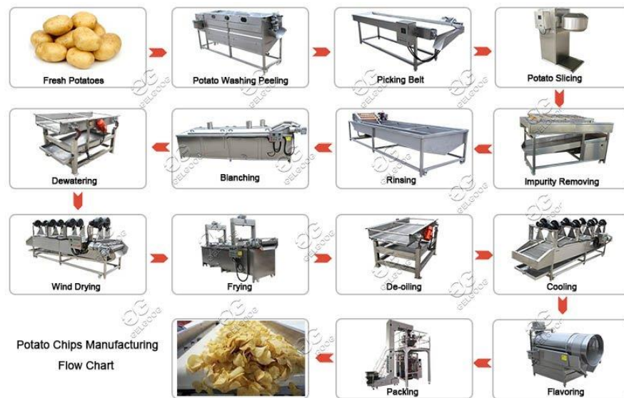
Εικόνα 34. Βιομηχανικό διάγραμμα ροής της παραγωγής των chips πατάτας (Πηγή: chipsfryer.com)
