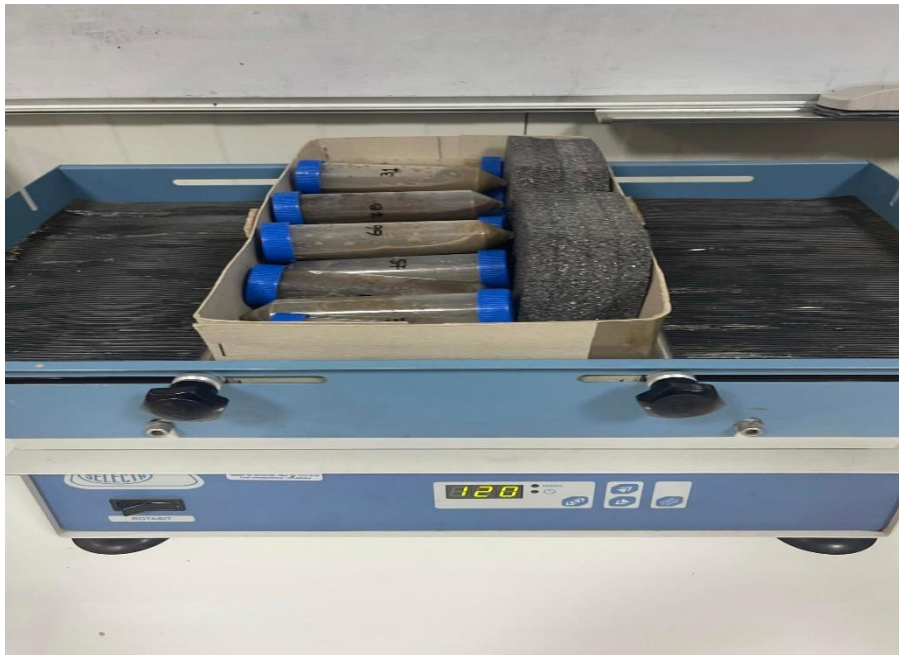
Εικόνα 2.6B. Ανακινητήρας εργαστήριου με τα δείγματα εδάφους.
