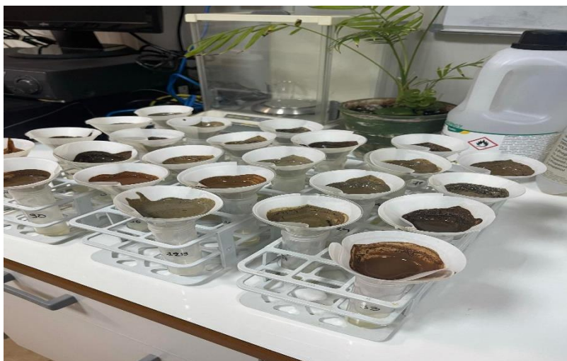
Εικόνες 2.7B-2.8B. Διήθηση δείγματος με διηθητικό χαρτί και χωνί.
