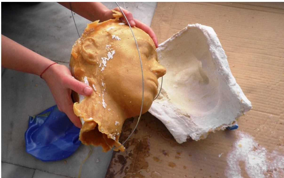
Εικόνα 38 Ολοκλήρωση διαδικασίας παραγωγής κέρινου εκμαγείου από το αρνητικό καλούπι γυψόγαζας
