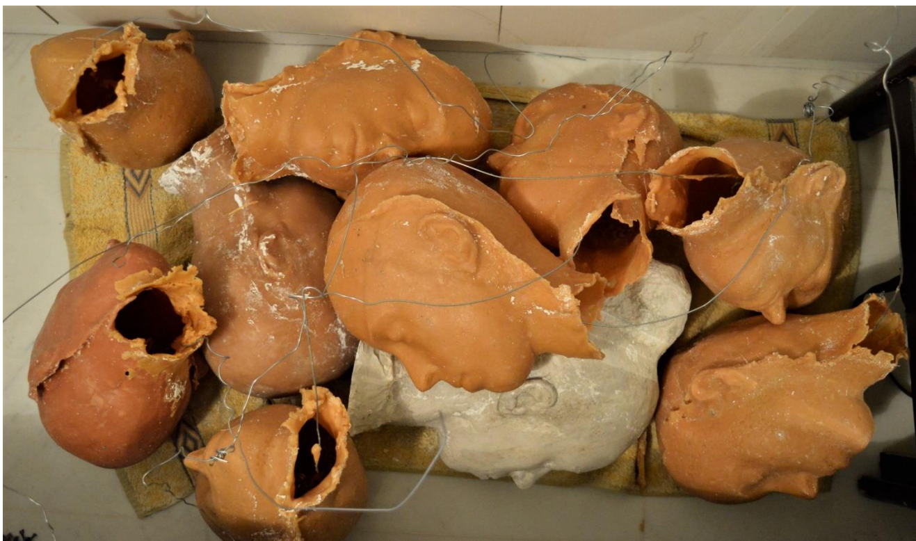
Εικόνα 44 Κέρινα εκμαγεία μαζί με το γύψινο εκμαγείο, 9 κέρινα και 1 γύψινο-μήτρα
