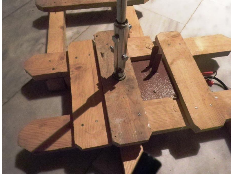
Εικόνα 49 Η ένωση των δύο σωλήνων με βίδες σπειρώματος και παξιμάδια
