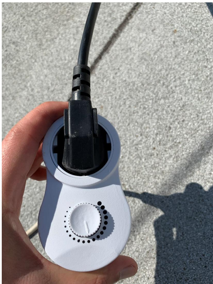
Εικόνα 57 Σύνδεση μοτέρ σε ροοστάτη
